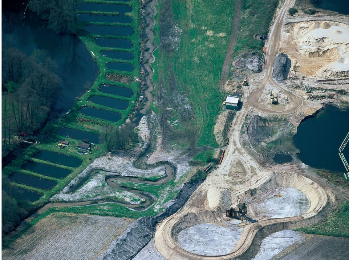
Abb. 30: Profilaufweitung und Laufverlängerung am Furlbach (Foto: WOL)
